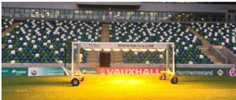
Rys. 33 Lamy do naświetlania murawy stosowane w celu zwalczania skutków zacienienia
