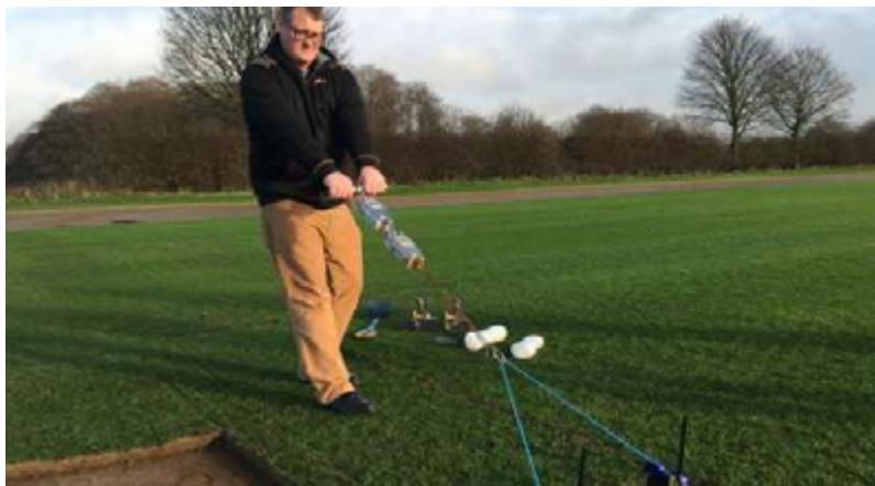
Rys. 23 Testowanie wydajności murawy za pomocą badania wytrzymałości trawy na rozerwanie opracowanego przez firmę Hayden (wg Załącznika 2).
