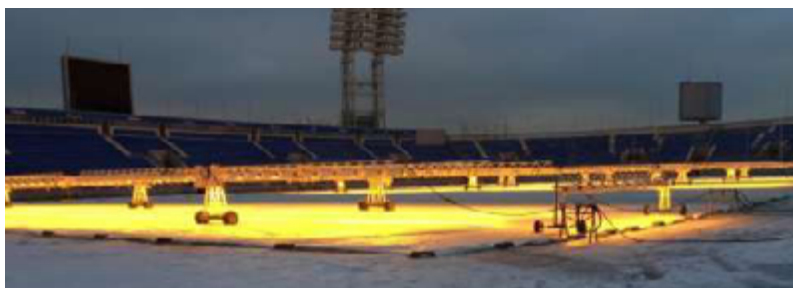
Rys. 27 Oslona przeciwśniegowa i naświetlenie nad osłoną
